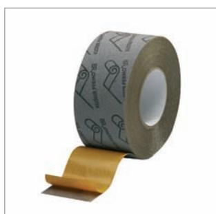
Permo® HD constitue la solution idéale pour les raccords extérieurs des écrans de sous-toiture dans les zones exposées aux chocs et aux chevauchements. Cette bande convient également pour la réparation de petits coups ou de petites fissures tout en restant perméable. La bande adhésive simple face à support Permo® perméable à la vapeur comporte une bande de protection facilement détachable : elle est idéale pour tous les travaux de toiture et de façade.
